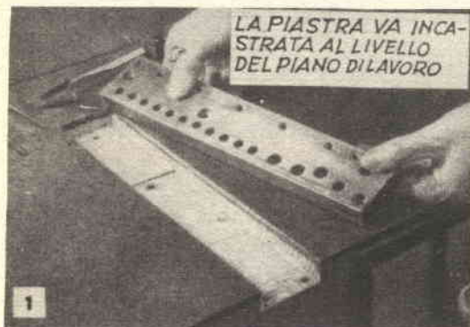
PER TRATTENERE PEZZI DA PIALLARE
